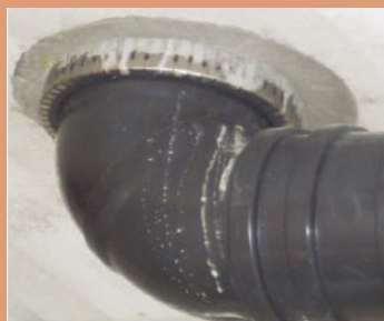
Phase I Temperaturen bis 300 °C (Auslösung der Brandschutz- manschette bei 180 °C)
