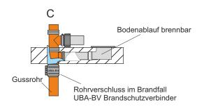
Die Verwendbarkeitsnachweise sind zu beachten. Insbesondere die Spaltabdichtung im Deckenbereich und die Einbauhöhen sind unterschiedlich.
